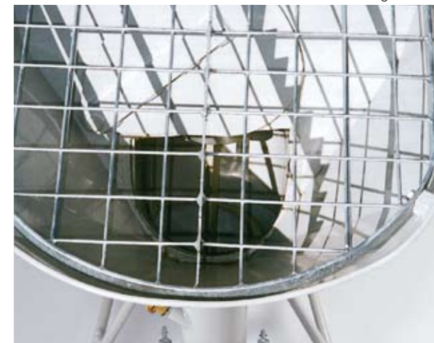
L'accesso alla camera di miscelazione è stato allargato del 40%. Il materiale secco fluisce in tal modo ancora meglio.
