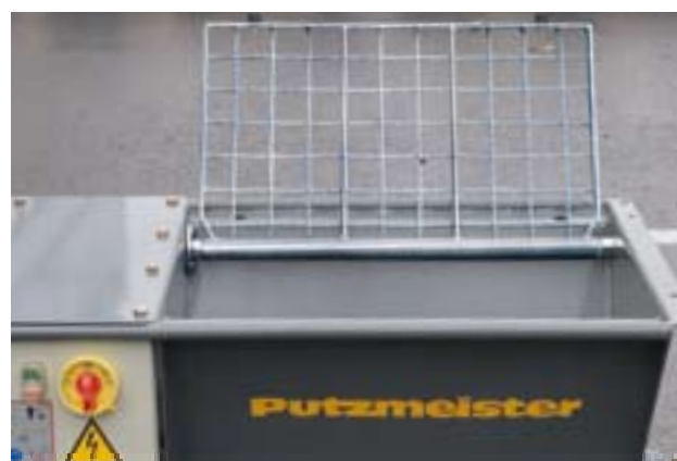
Grille de sécurité à grand débattement. Cela facilite l'accès à la trémie de pompage (p.ex. pour le nettoyage).
