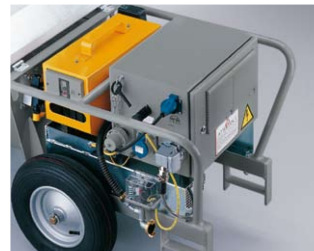
Dotazione completa, incluso il compressore. Con la SP 5 si può iniziare subito la posa. Non è necessario un compressore ausiliario.
