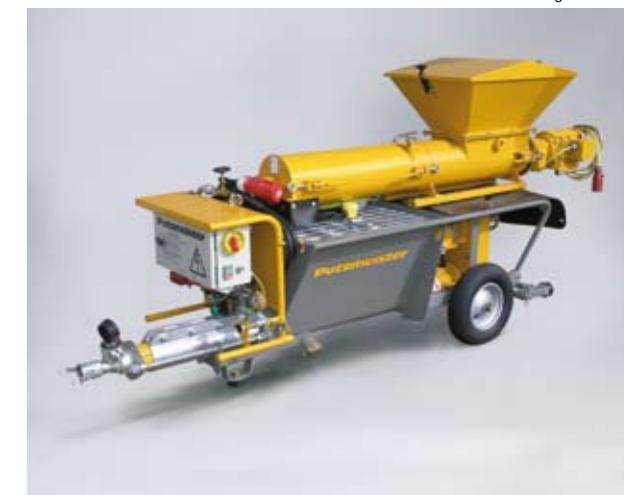
Ova S 5 EV/CM pumpa (sa neprekidnom mešalicom) meša, pumpa i prska zamešani materijal.
