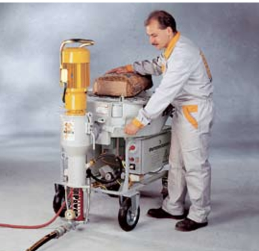
Spremnik materijala i cijev mješalice su međusobno odvojeni. Kada se otvori zapor, suhi materijal ulazi u cijev za miješanje.
