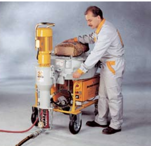
Nádrž na materiál a směšovací trubice jsou oddělené. Otevřete hradítko a suchý materiál se přesune do směšovací trubice.
