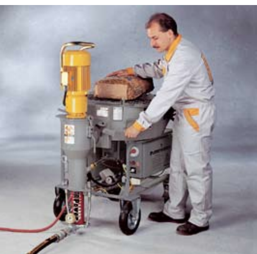
De trechterbak en de mengzone zijn van elkaar gescheiden. U opent de schuif en het droge materiaal stort in de mengzone.
