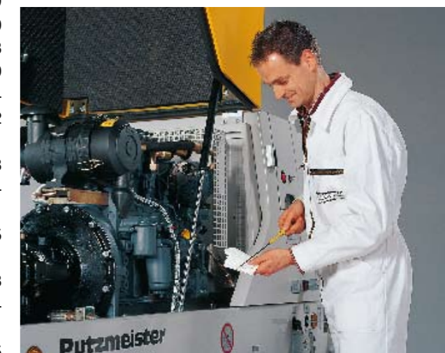
Không có gì cản trở. Tất cả các khu vực cần được chăm sóc hoặc bảo dưỡng đều được tiếp cận thuận tiện, như ở đây, thước kiểm tra mực nhớt.
