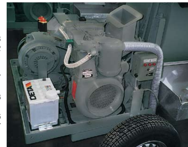
Der 2-Zylinder Dieselmotor ist extrem robust und wartungsarm. Er leistet 12,5 kW.
