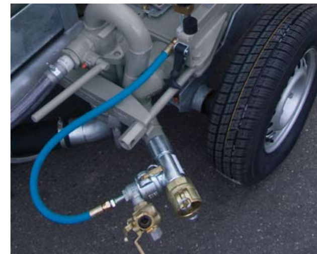
Die P 13 zählt zu den extrem wartungsarmen Verputzmaschinen. Die wenigen Verschleißteile sind schnell ausgetauscht und somit Servicearbeiten schnell erledigt.
