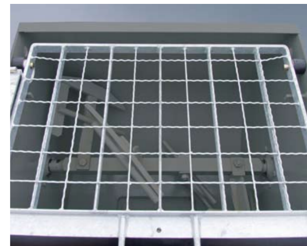
Das Sieb hat einen mechan. Rüttelantrieb und ist im verzinkten Mörteltrichter eingeleget. Es kann zur Reinigung herausgenommen werden.
