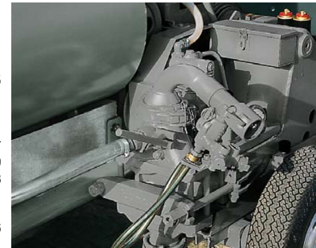
Die Doppelkolbenpumpe (hier die KK 139 mit bis zu 120 l/min Pumpleistung) sorgt für stoßfreies Arbeiten am Spritzgerät.
