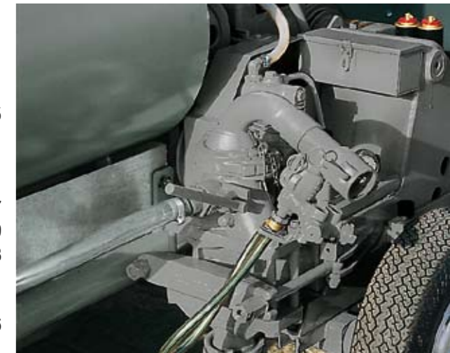
La pompe à double pistons (ici la KK 139 avec un débit jusqu'à 120 l/ mn) assure un travail sans à-coups à la lance.
