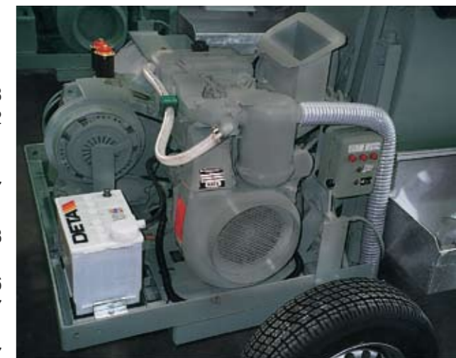
Le moteur Diesel bicycl. est extrêmement robuste et demande peu d'entretien. Il a une puissance de 12,5 kW.
