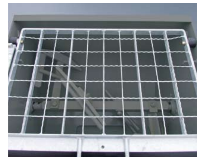
Le tamis possède un entraînement mécanique et est inséré dans la trémie mortier galvanisée. Il est amovible pour faciliter le nettoyage.
