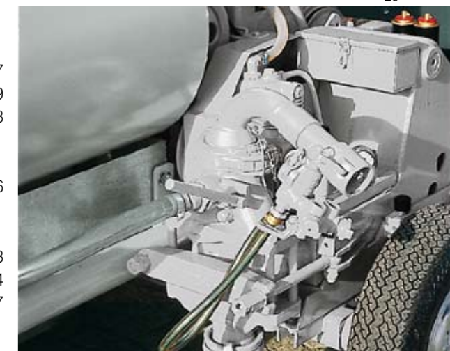
La pompa a doppio pistone (qui la KK 139, con portata della pompa fino a 120 l/min) permette l'impiego della lancia senza occlusioni.
