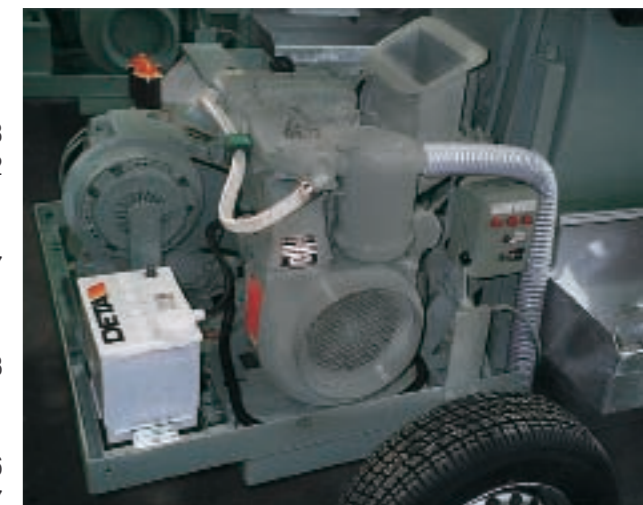
2-cylindrowy silnik wysokoprężny jest bardzo wytrzymały i nie wymaga dużego czasu na konserwację. Ma moc 12,5 kW.
