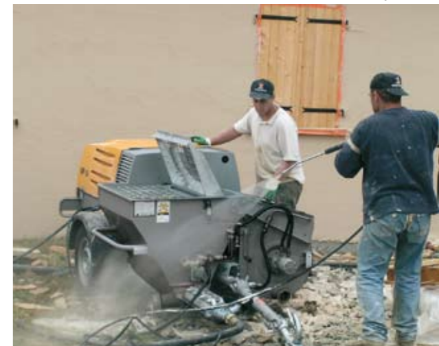
Eenmaal de werkzaamheden zijn afgelopen, kan u de Beliso reinigen met de geïntegreerde 120 bar hogedrukreiniger - snel en efficiënt.
