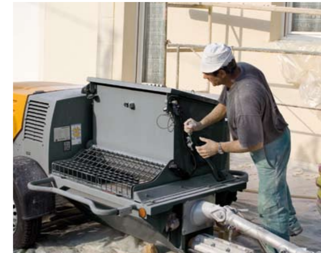
Parmi les 3 variantes de malaxeurs, choisissez celle qui vous convient. Vous pouvez voir ici le malaxeur à trappe robuste et bon marché de la variante BMT.
