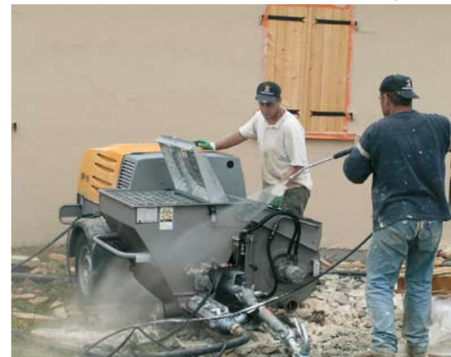
Après l'utilisation, nettoyez votre Beliso rapidement et en profondeur à l'aide du nettoyeur haute pression 120 bar intégré.
