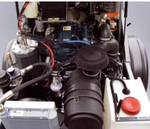
4 Der neue wassergekühlte Dieselmotor entspricht den neuesten Abgasnormen (COM III).
