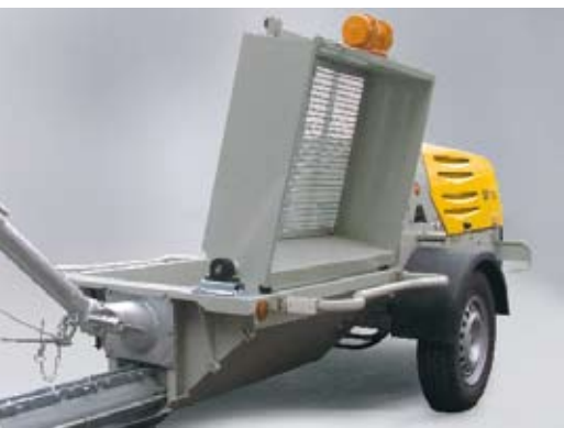
Le tamis sur la grille doté d'un vibreur de 12 V empêche que des grains surclassés et les corps étrangers parviennent dans la pompe.
